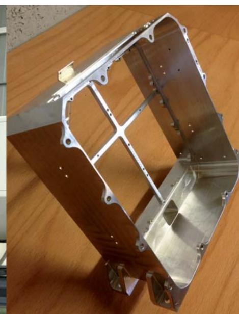
Pièce de satellite usiné dans la masse pour le projet européen "SOLAR ORBITER STIX DEM".
